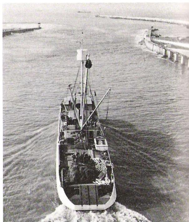
Ce navire construit à Bordeaux en 1969 est du type «Océanique» aux caractéristiques plus importantes que l'«Ile-de-Sein» puisque sa longueur H.T. est de 51,95 m, sa largeur de 10,89 ; il est donc proche du «Morgat» avec toutefois un volume de cuves pour le stockage plus vaste : 980 m<sup>3</sup>. Certaines cuves peuvent entreposer de l'appât vivant.
