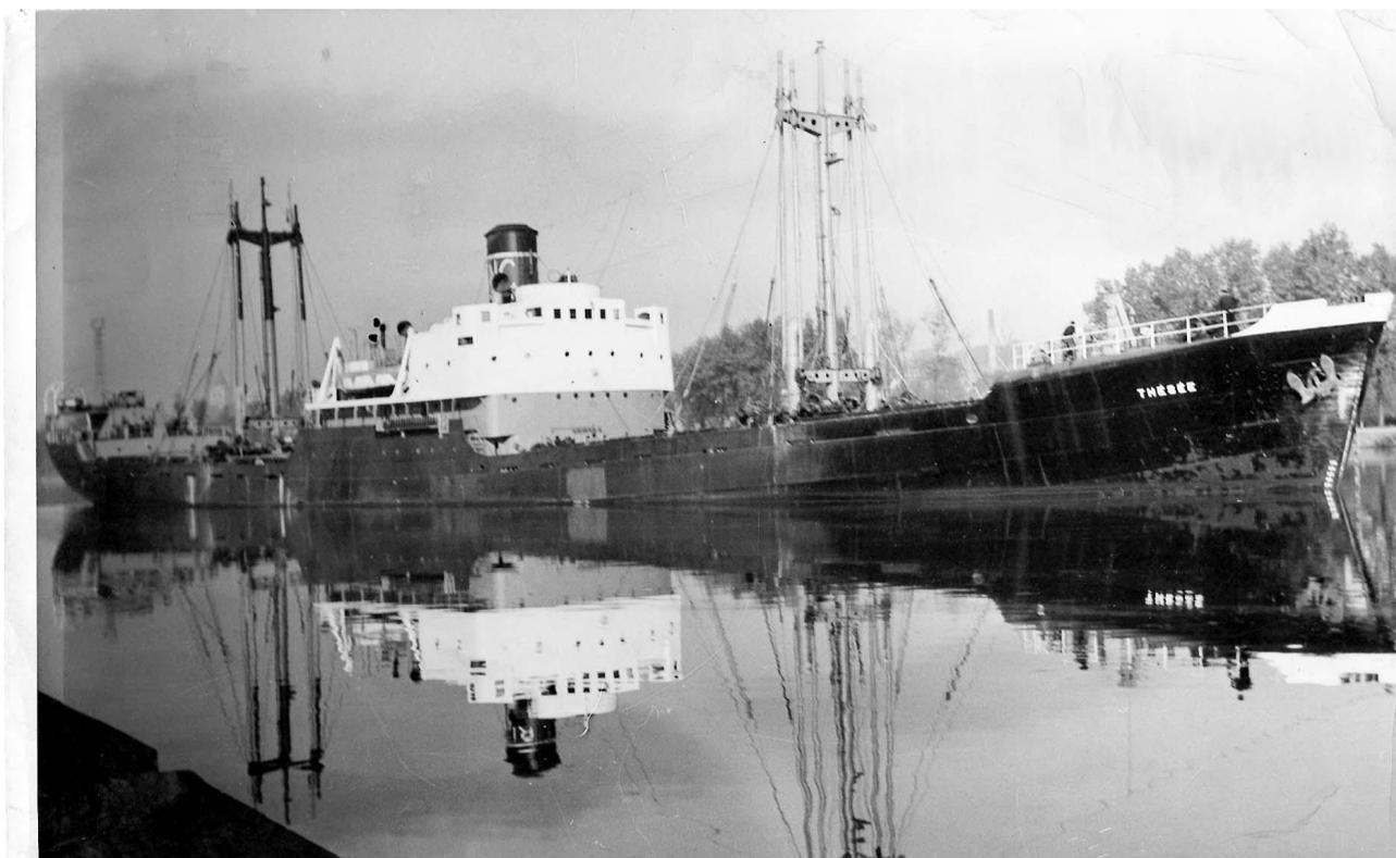
Le *THÉSÉE* mesure 114 mètres de longueur environ sur 14 de large. Il est mu par une machine à vapeur par chaufferie à mazout du type Vickers Skinner de 1 810 chevaux de puissance, lui permettant de tenir une vitesse moyenne de 11 nœuds.
